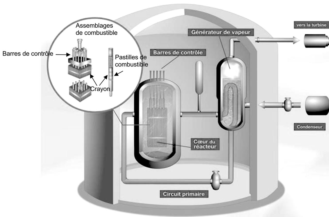
Figure 1 – Structure schématique d'un réacteur nucléaire
