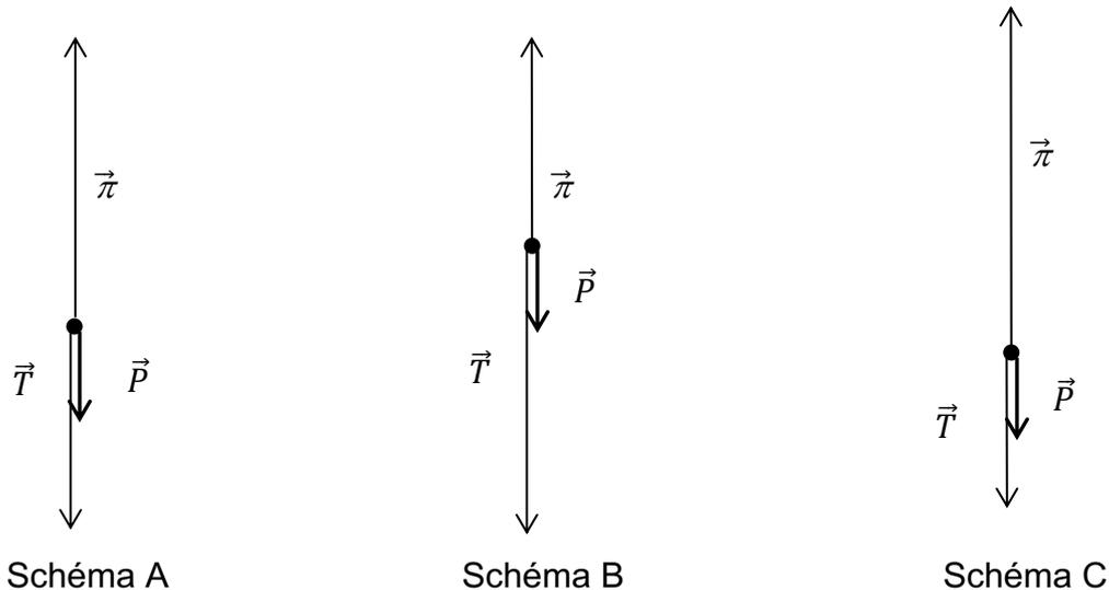
Figure 3 – Représentations schématiques des forces appliquées à l'ensemble {ballon + nacelle}, symbolisé par un point. Les forces sont à l'échelle.
